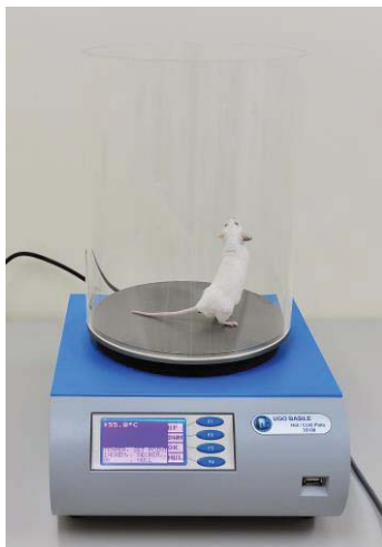
Слика 9. Тест излагања врућој плочи
