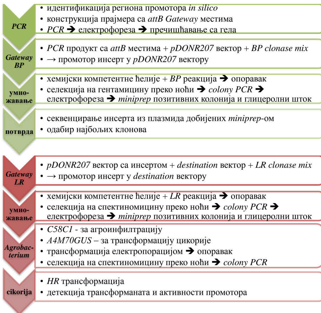
Слика 32. Шема експеримента амплификације и клонирања промотора.
