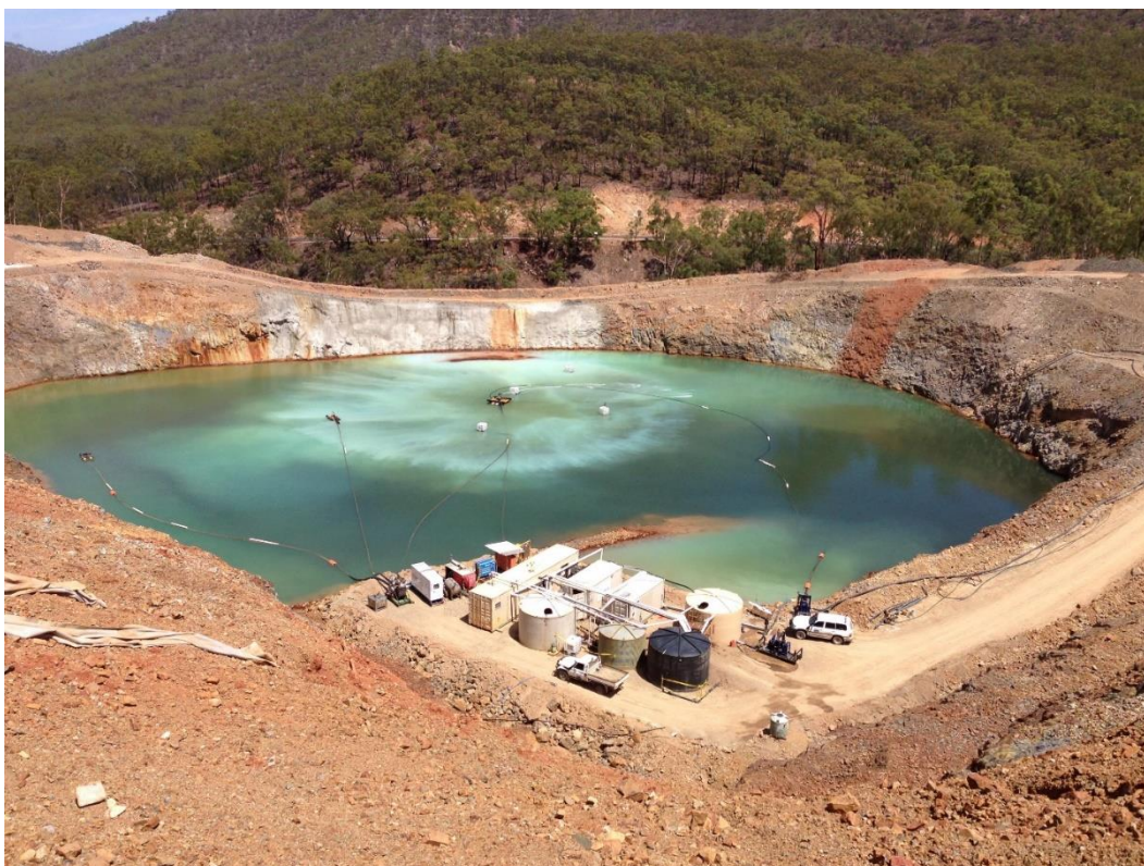
Slika 1. Industrijske otpadne vode (efluenti) u akumulaciji nastaloj eksploatacijom ruda. U toku je nebiološki tretman otpadne vode adsorpcijom na aktivnom uglju (Preuzeto sa: www.csiro.au )
