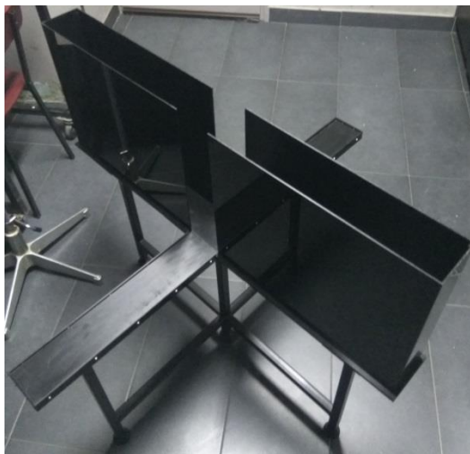
Slika 3.6. Uzdignuti krstasti lavirint za praćenje anksioznog ponašanja pacova (Laboratorija 56, IBISS).
