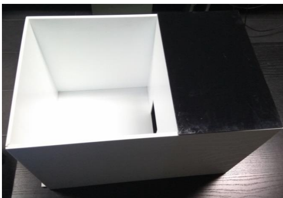
Slika 3.5. Svetlo/tamna kutija za praćenje anksioznog ponašanja pacova (Laboratorija 56, IBISS).
